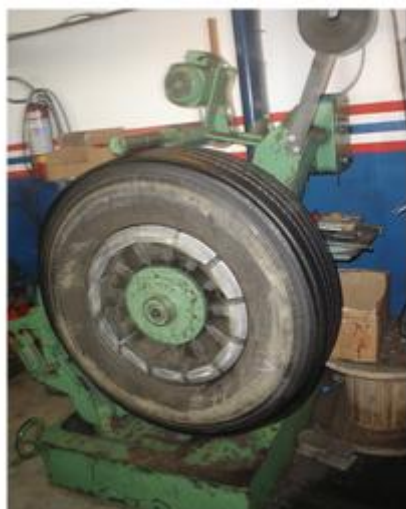
Figura 13: Fixação da nova banda de rodagem
