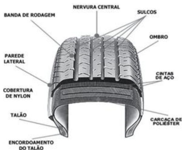
Figura 2: Estrutura do pneu
