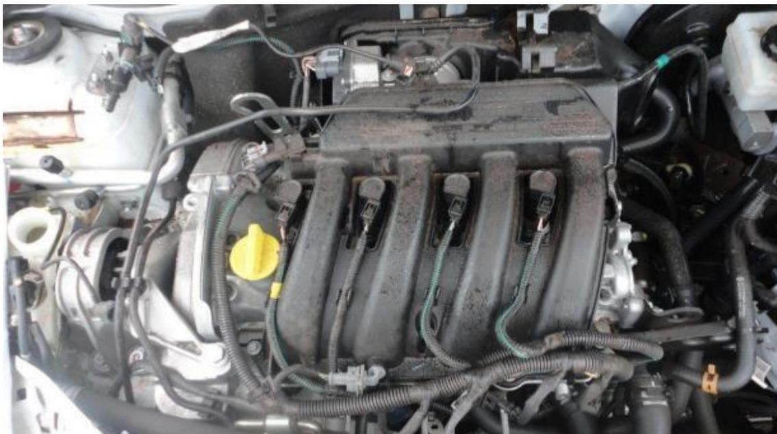
**Figura 10:** Motor Duster 1.6 2014 (Fonte: Elaborado pelo autor).
