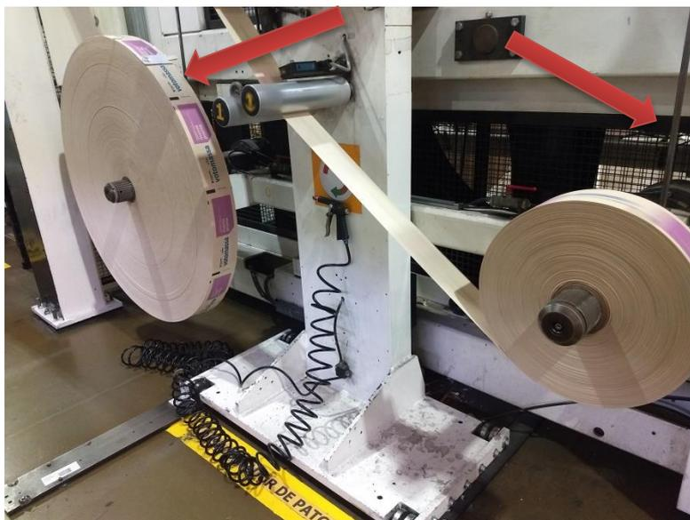
Figura 7 - Sensores de presença nas bobinas de Patch.
