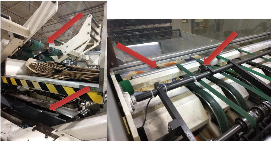
Figura 6 - Sistema *Poka Yoke* para eliminação de defeitos
