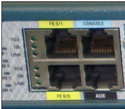
Figura 40. Interface Console (conexão superior direita).
