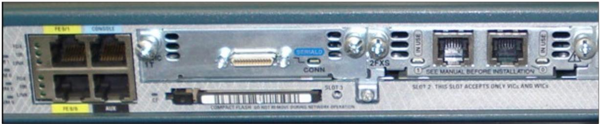
Figura 48. Vista geral das interfaces do roteador.
