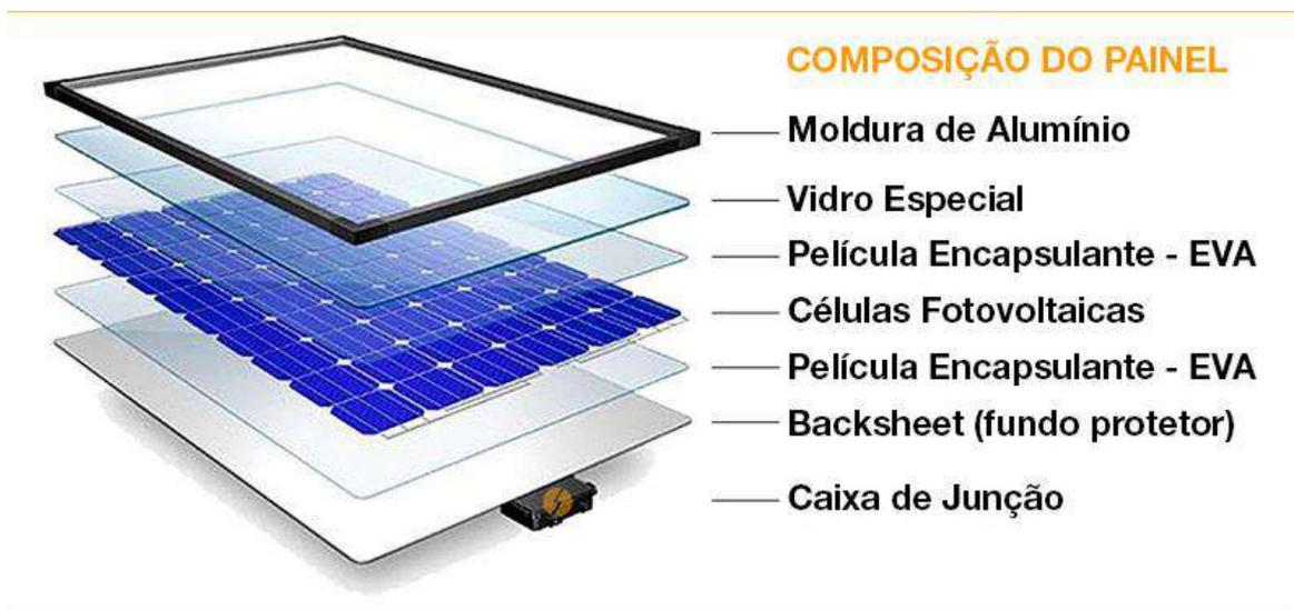
Figura 46 - Composição do Painel Fotovoltaico
