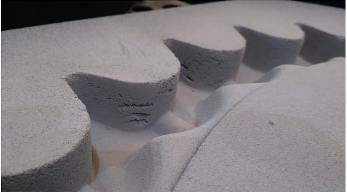
**FIGURA-4** MOLDE DE AREIA COM DESCAMAÇÃO
