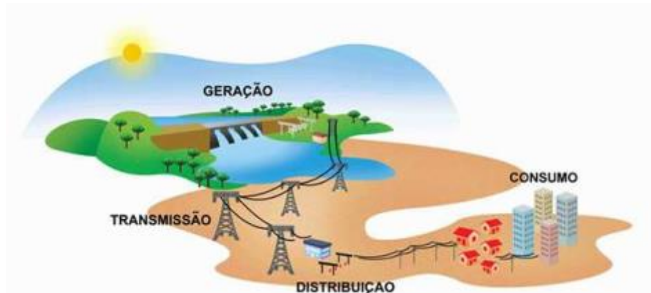
Figura 3 – Sistema Elétrico de Forma Ilustrativa.
