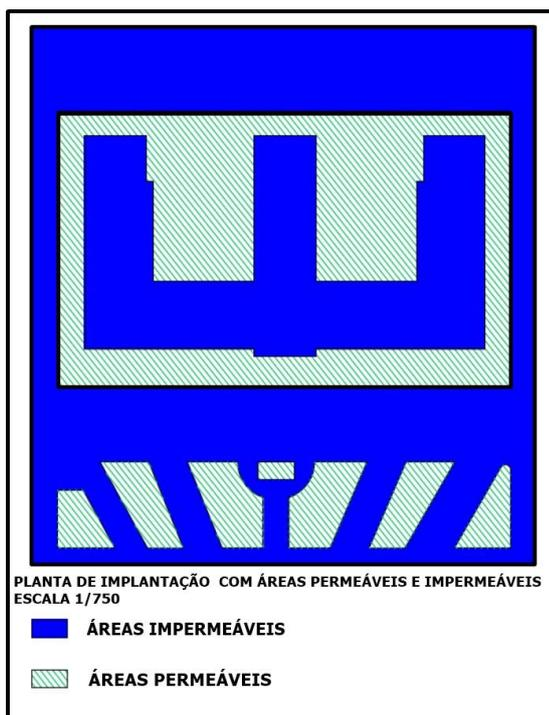
**FIGURA 27: IMPLANTAÇÃO COM ÁREAS PERMEÁVEIS E IMPERMEÁVEIS**
