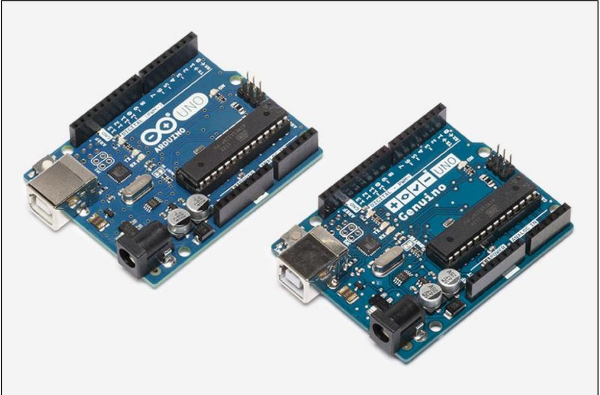
*Figura 1 - Placa Arduino UNO. Fonte: ARDUINO*
