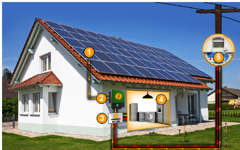
FIGURA 2 - Sistema solar conectado a distribuidora Fonte: SOLAR, 2017.
