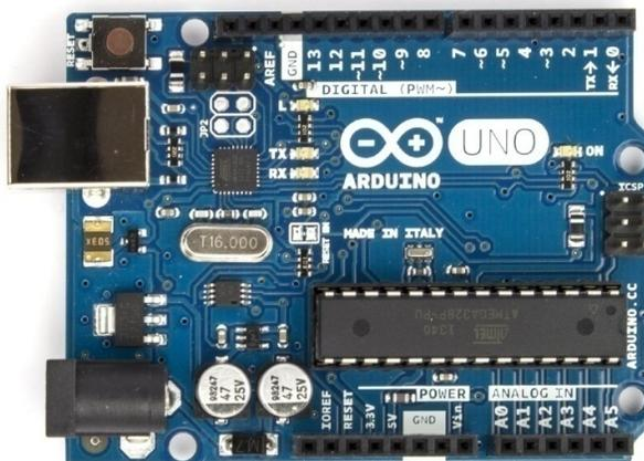
**Figura 1 - Placa Arduino**
