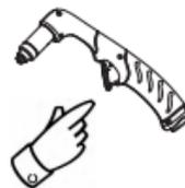
Inspecione o gatilho para ver se há desgaste. Inspecione o corpo da tocha para ver se há alguma rachadura ou fios expostos. Substitua qualquer peça avariada.
