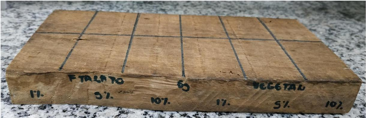
**Figura 11** – Aplicação das resinas em madeira com 8g EPS
