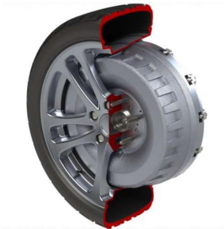
Figura 13-Motor em roda utilizado em um carro.
