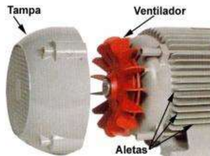
Figura 14-Modelo de resfriamento de um motor.
