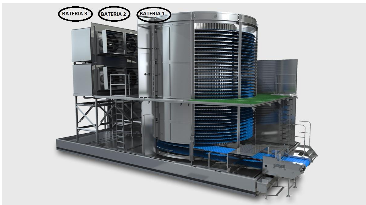
Figura 6-Giro Freezer e suas baterias formadoras de frio 1,2,3.
